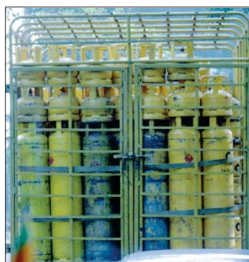
Die Gasflaschen verfügen alle über einen Sicherheitskragen, sie sind stapelbar und werden im Handel in einer Art Metallkäfig befördert.
