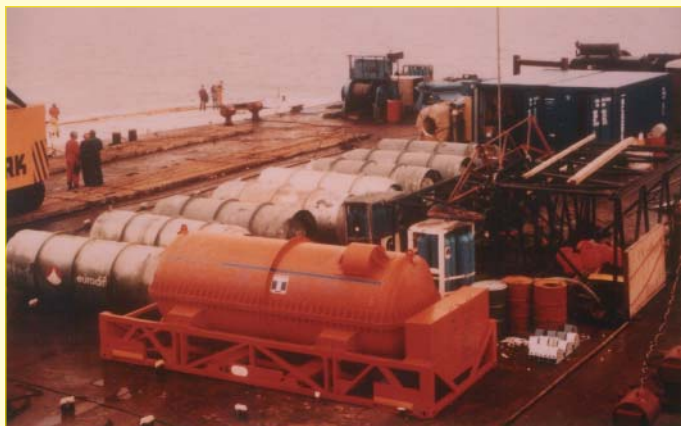
Ein Behälter war am Ventil undicht, 15 Kilo Wasser waren in den Behälter gelangt. Noch während der Bergung konnte das Ventil geschlossen werden. Ungeachtet dessen hat man den Behälter in einen besonderen Bergungsbehälter (im Bild vorn) verladen. Nach Angaben des belgischen Umweltministeriums ist zu keiner Zeit in der Nähe der Mont Louis erhöhte Radioaktivität oder Säure im Wasser festgestellt worden.
