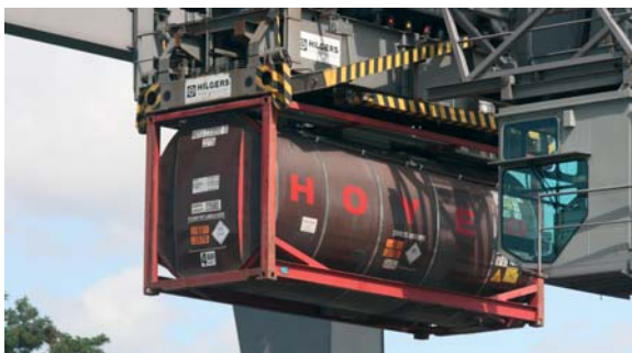
Die Container werden vom Containerauflieger des Lkw abgehoben und zunächst zwischengelagert. Danach werden sie auf die Containertragwagen der Bahn verladen.
