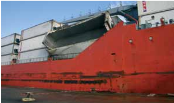
Der Bananenfrachter „Duncen Island“ hatte Container verloren. Dabei wurde der Schiffstank beschädigt. Die Container konnten geborgen werden, das Schiff wurde in den Cuxhavener Hafen beordert.
