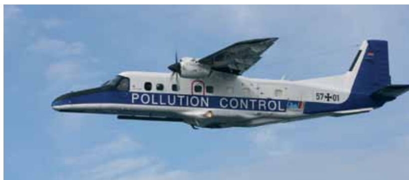
Mit dem Flugzeug Do228LM werden die deutschen Gewässer ständig überwacht. Das Flugzeug ist mit speziellen Sensoren zur Erkennung von Verschmutzungen ausgerüstet.
