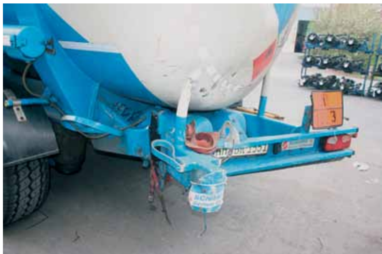
Unfälle mit modernen Mineralöltanks werden immer seltener. Bei Auffahrunfällen hält der Tank in den meisten Fällen den Unfallbeanspruchungen stand.
