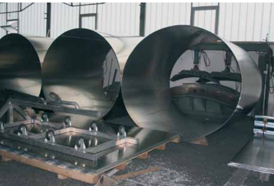
Gefertigt werden Tankauflieger im Baukastensystem. Je nach Kundenwunsch sind längere und kürzere Tanks bei gleichem Tankquerschnitt möglich.
