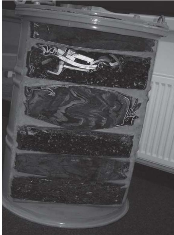
*Schwach- und mittelaktive Abfälle werden zusammengepresst und mit Bitumen oder Beton in einem Metallfass fixiert. Diese Fässer sollen künftig im ehemaligen Erzbergwerk Konrad endgelagert werden.*
