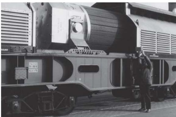
*Bevor Transporte mit radioaktiven Stoffen auf die Bahnreise gehen, wird die Oberflächendosis gemessen. Vorher hat ein sog. Wischtest stattgefunden, bei dem eine mögliche Kontamination gemessen wird. Die Typ-B-Behälter haben übrigens ein Gewicht von etwa 100 Tonnen.*
