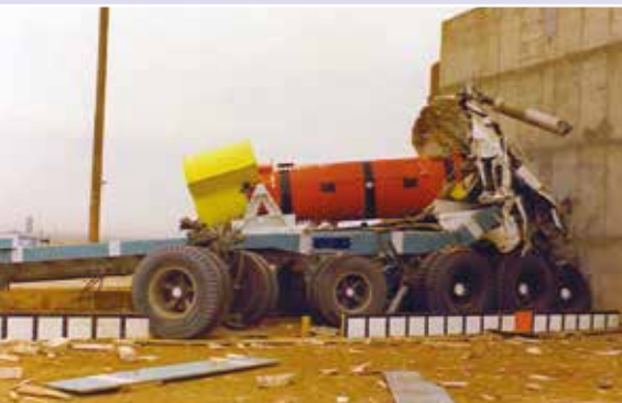
Raketenschlitten gegen Betonwand, Typ B-Behälter blieb dicht!
