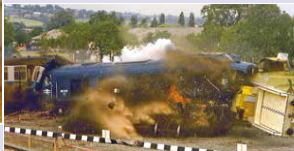
Lok gegen Typ B-Behälter, 160 km/h – Typ B-Behälter blieb dicht!
