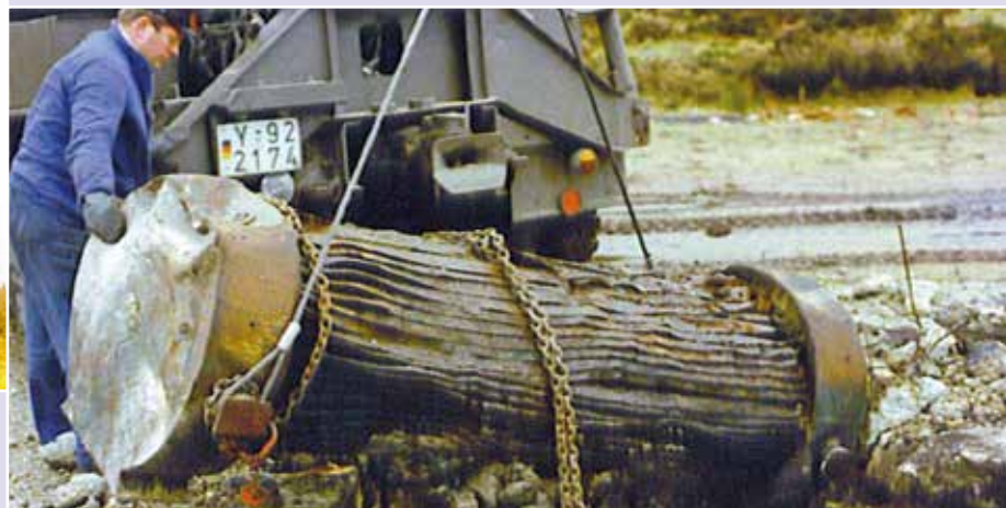
Typ B-Behälter blieb dicht!!
