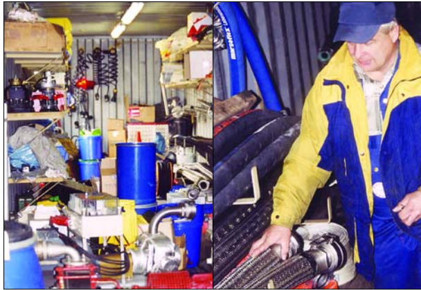
Der Schein trägt (links): zusätzliche Ausrüstung, zum Beispiel eine Pumpe mit Spindelförderung für extrem dickflüssige Stoffe, in scheinbar chaotischer Lagerung. Die unterschiedlichen Schläuche (rechts) sind notwendig, um die Werkstoffverträglichkeiten der zahlreichen Füllgüter zu berücksichtigen.
