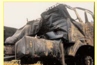
Das Tankfahrzeug, das den Unfall verursacht hatte, war vollständig ausgebrannt. Doch die Sachverständigen konnten noch feststellen, dass das Tankfahrzeug technisch nicht in Ordnung war. Besonders wurde bemängelt, dass die Bremsen abgefahren waren und die Nachstellvorrichtung der Bremsen nicht funktionierte.
